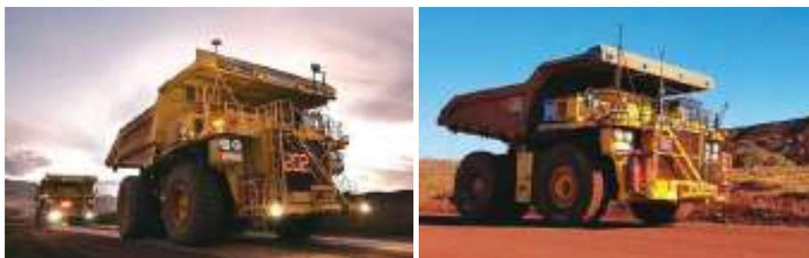
图 2-4 小松公司以 830E、930E 矿山自卸卡车为基础研制的无人车，长 14.15 米，宽 7.32 米，高 6.88 米，配一台 2500 马力发动机。整车重量 386 吨，额定载重 221 吨
