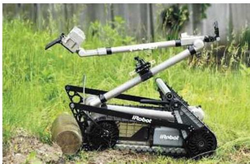
图 1-13 著名的军用无人车、排爆机器人 PackBot，是美国 iRobot 公司<sup>①</sup>研制生产的
