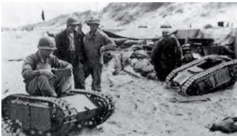
图 1-12 德国的 B1 遥控爆破车
