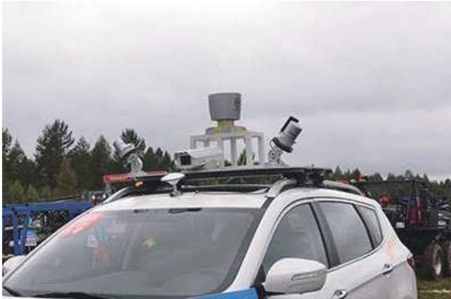
图 3-2 这辆无人车在车顶装了一个 64 线激光雷达，作为主探测器，两侧斜伸出来的是 32 线激光雷达，负责探测车体两侧斜下方的空间。中间的摄像头和白色圆盘的 GPS 天线，也是无人车上很常用的传感器，前者负责识别车道线、路标，后者用于得到本车的坐标
