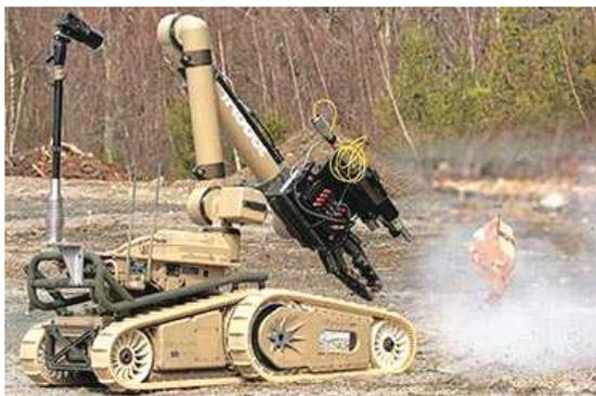
图 1-2 排爆机器人，就是无人车上装了一套机械臂，因此严格来说属于无人车的一种
